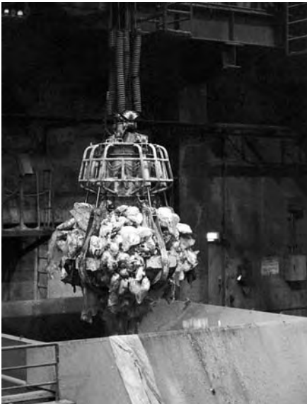
千代田クリーンセンターの焼却処理施設。可燃ごみをクレーンで吊り、焼却炉に投入する様子。3市5町から集まる膨大な可燃ごみを処理するため、焼却炉は1年間ほとんど休むことなく24時間体制で燃やし続ける
