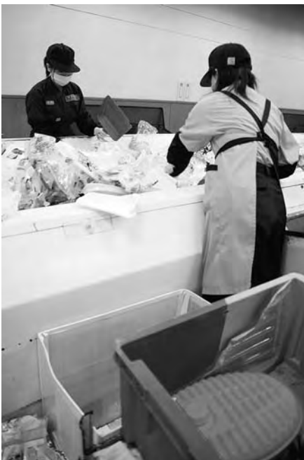
同センターのリサイクルプラザ。プラスチック製容器包装とペットボトルの2ラインを、7名の従業員が手作業で不適合物を取り除く。次々と流れてくるごみの中には、湯たんぽや瓶など明らかに違うものが混ざっていた
